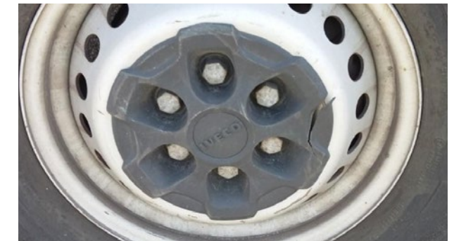
Radabdeckungen: Verformt, gebrochen, Material fehlt oder entfernt
