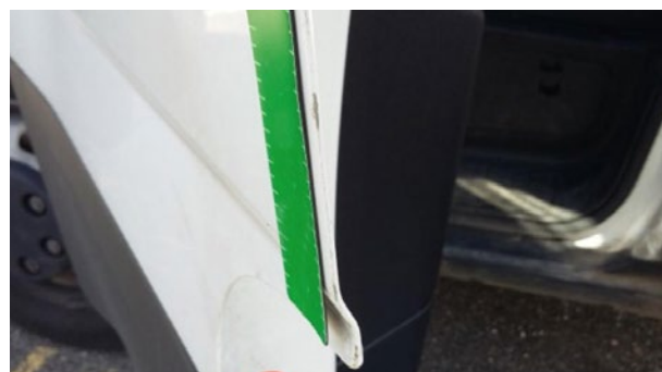
Lackschaden an Türkante
