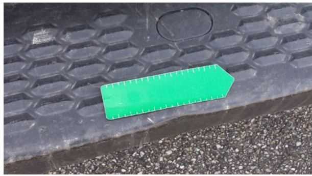
Hintere Trittbretter: Leichte Verformung
