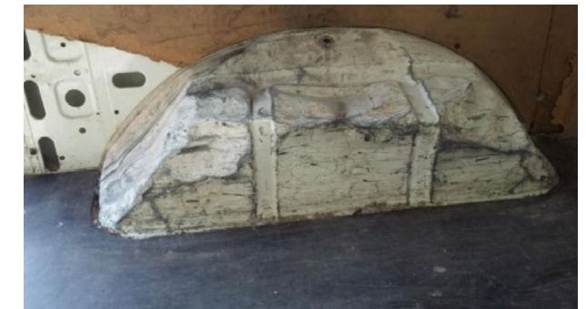
Innere Verformungen: Durchdringungen, Schnitte, Verformungen, die nicht auf wirtschaftliche Weise repariert werden können. Stoffverändernde und nicht entfernbare Ablagerungen (Pulver, Lackfarbe usw.) (Radkasten nicht wiederherstellbar, wenn Reparaturzeit < 3h)
