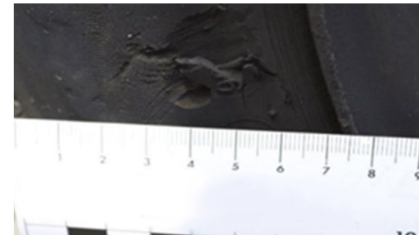
Reifen: Beschädigungen > 3 mm, abgetragen
