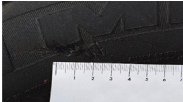
Reifen: Beschädigungen \leq 3 mm (ERFÜLLT)
