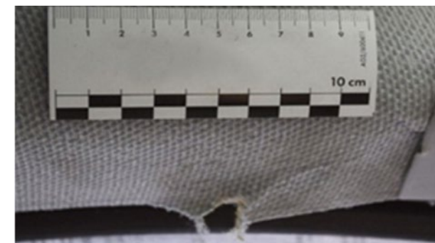
Stoffbezüge: Risse, Loch > 5 mm, nicht entfernbare Flecken
