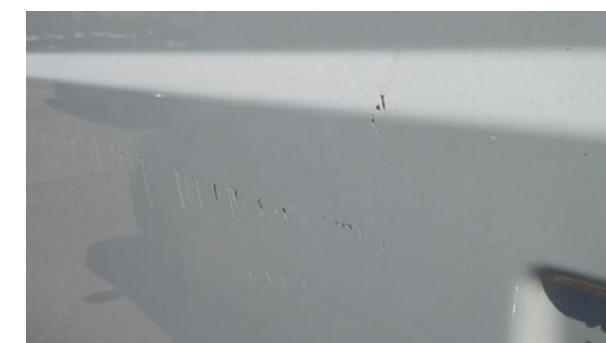
Kratzer > 20 mm Bitte beachten: Bei den hinteren Schwenktüren ist es nicht möglich, nur eine zu lackieren
