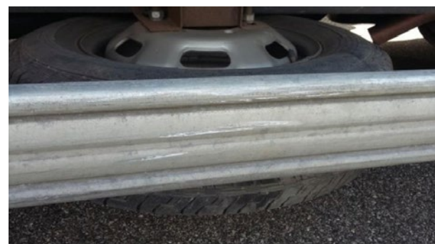
Seitenunterfahrerschutz: Leichte Kratzer
