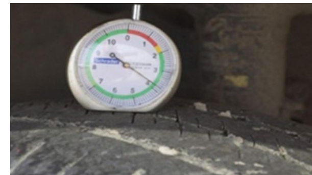
Reifen: Profiltiefe < 5 mm Anmerkung: Der Reifenverschleiß wird in der am meisten abgenutzten Profilirille am Reifen gemessen.
