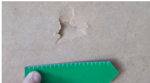
Innenraumverkleidung : Kleine Stoßspuren
